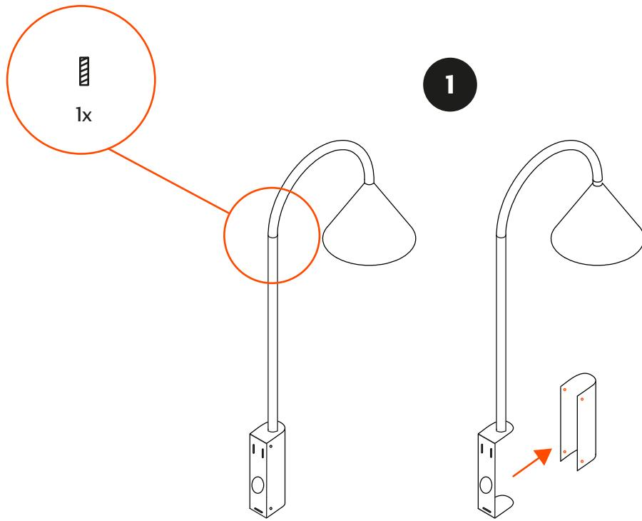
Per procedere al fissaggio della lampada al muro svita le 4 viti presenti sul profilo del basamento, quindi rimuovi la placca.
